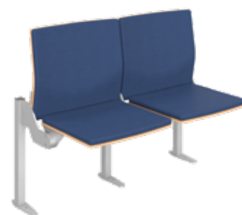
LUPU zadná lavica LP-AUD-132-TKL konštrukcia 30x30 mm joklovina, sedák a operadlo buková preglejka, čalúnenie s 70000 cyklom oteruvzodnosti
